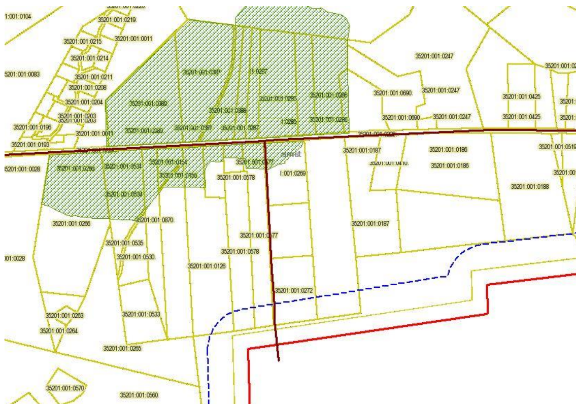
Joonis 8.2 Mäeeraldise piir (punane joon), kavandatava tegevusega eeldatavalt kaasnev kuivenduse mõjuraadius (sinine joon), Kaberla loodus- ja hoiuala (roheline viirutus) ning väljaveotee paiknemine (pruun joon)
