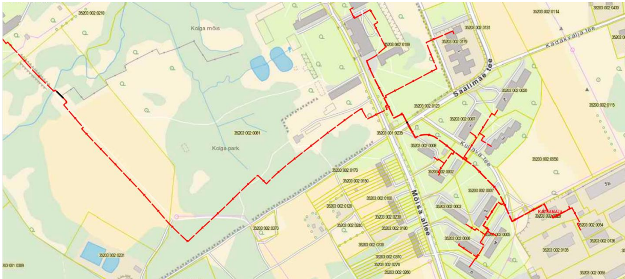
Joonis 16. Kolga kaugküttevõrgu skeem
